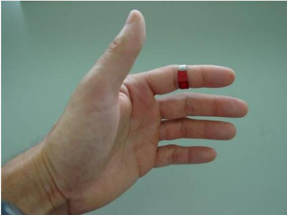
Abb. 1: Tragweise Fingerdosimeter
