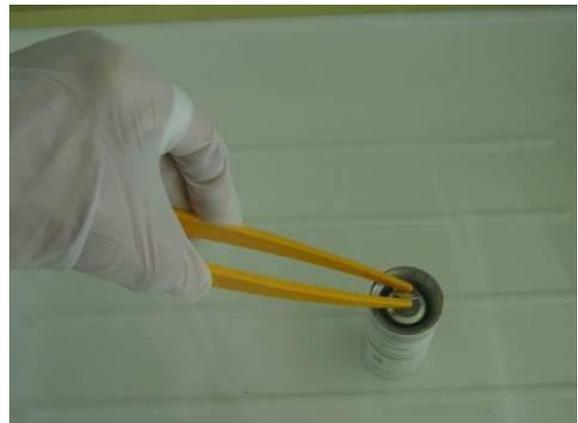
**Abb.11:** Entfernen der Septen-Schutzkappe mit Pinzette
