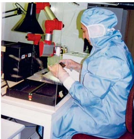
Fig. 12: une hygiène particulière et des mesures efficaces de protection de la peau sont recommandées lors de travaux avec des substances allergènes (ex. ci-dessus: collage avec des résines époxy).
