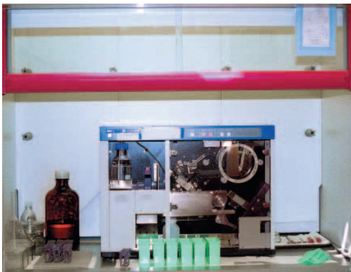
Figure 8 Automate pour le montage des coupes: diminution de l'exposition aux solvants grâce à une chapelle avec évacuation externe.
