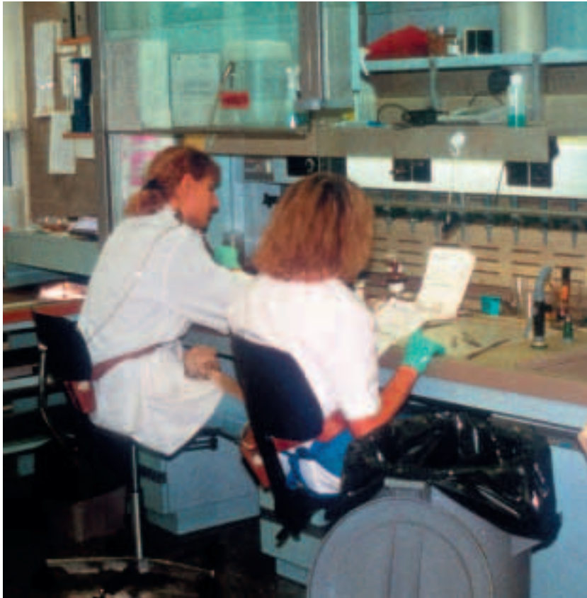
Figure 1 Poste de travail dans le local de préparation des coupes: chapelle avec évacuation de l'air vers l'extérieur (catégorie A).
