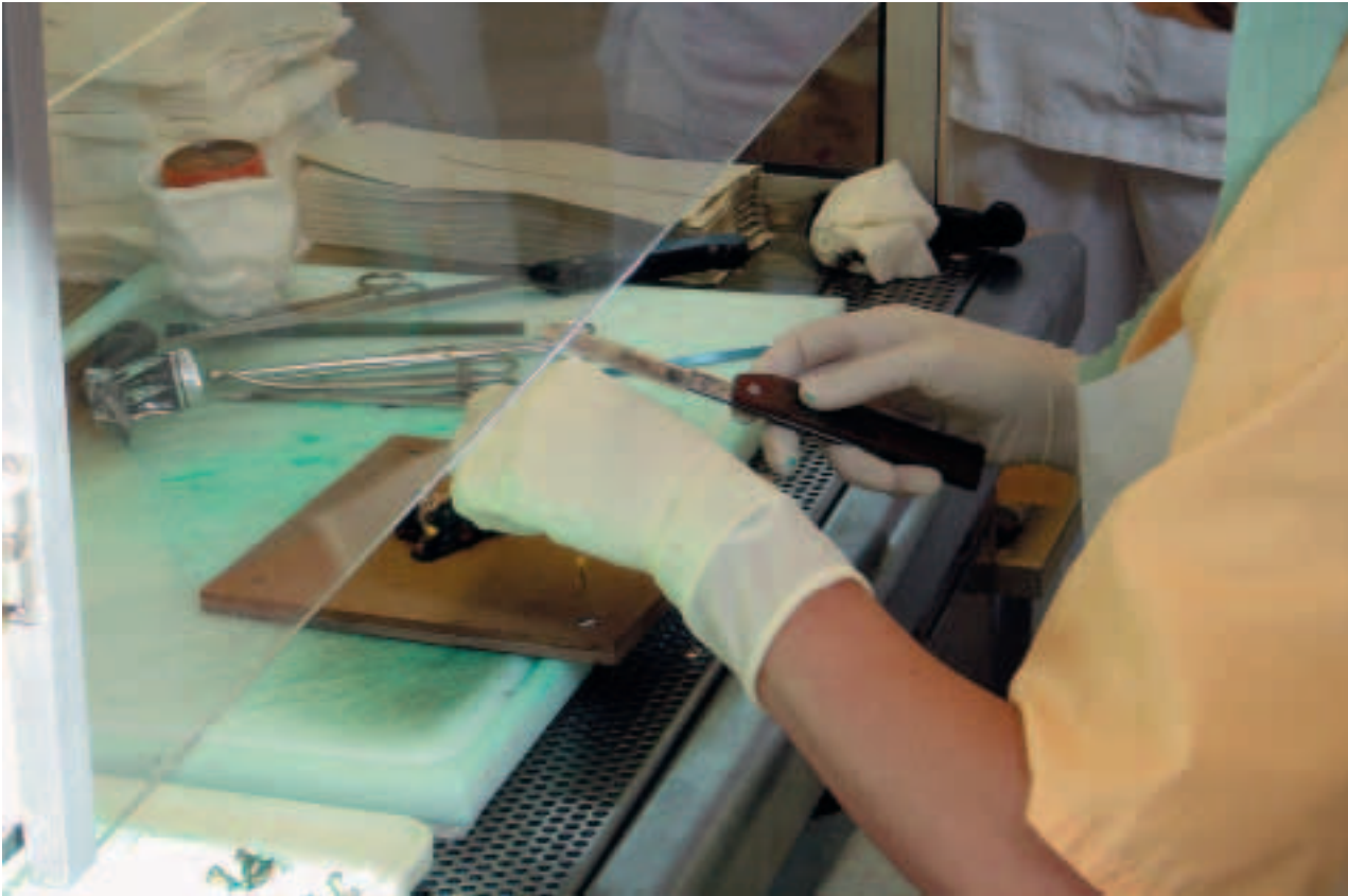
Abbildung 6 Arbeiten in einer Sicherheitswerkbank der Klasse II.
