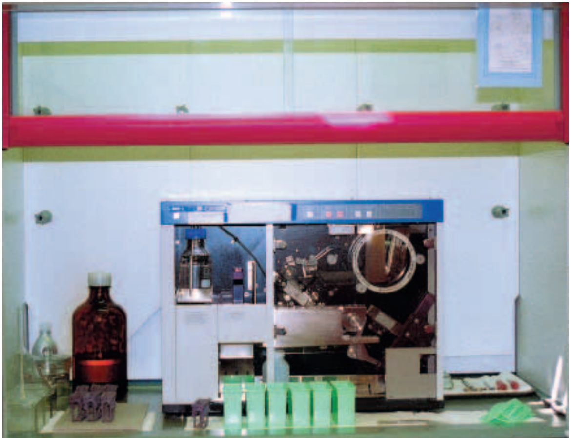
Abbildung 8 Eindeckautomat, zur Verringerung der Lösungsmittelsexposition in Kapelle mit Ablufführung platziert.
