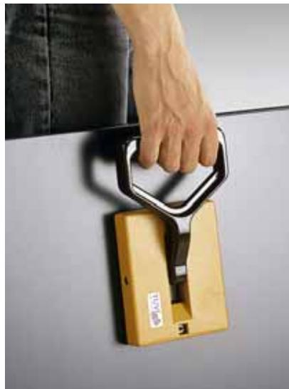
Bild 20: Magnetgriff für Stahlplatten.
