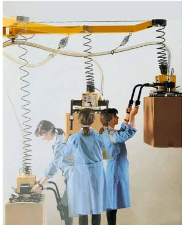
**Bild 22:** Gewichtsbalancer ermöglichen das Bewegen von Lasten ohne grosse Kraftaufwendung.
